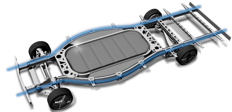
Beispielbild: Bionische Leichtbaustrukturen auf Basis verzweigter Bleche
